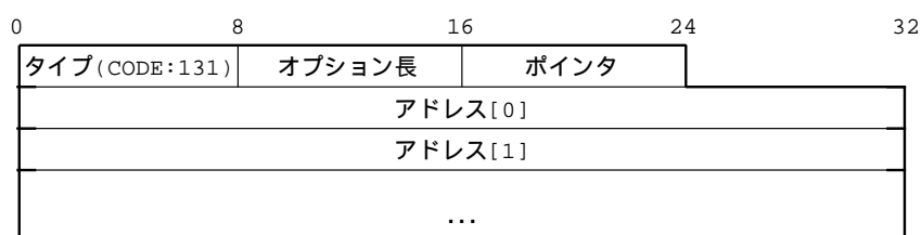
図 4.4: ソースルーティングオプションにおける非厳密な経路制御のフォーマット
