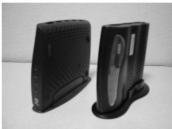
図 4: IPv6 ネットワーク接続用のケーブルモデム(右)と既存のIPv4ケーブルモデム(左)
